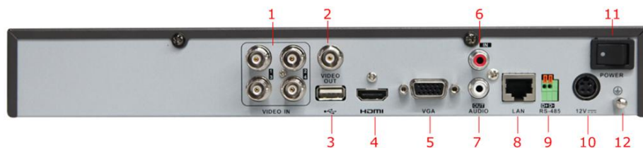
Afbeelding 1.4 Achterpaneel van DS-7204HVI/HFI-SH
