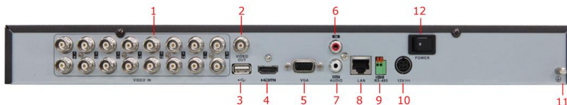
Afbeelding 1.6 Achterpaneel van DS-7216HFI-SH
